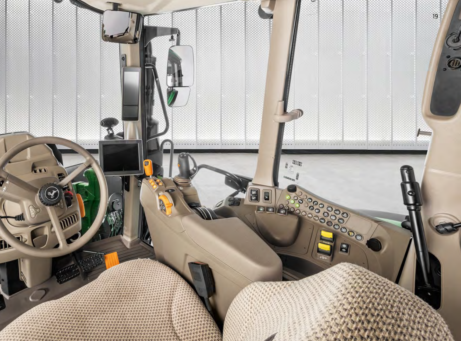
6M:n intuitiivinen käyttöliittymä: A-pilarissa oleva kulmapilarinäyttö ja uusi kompakti CommandARM™.
